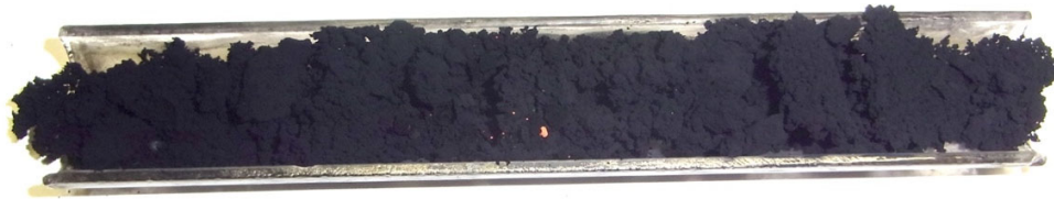
図1 水素生成時に同時に生成されたカーボンナノチューブ塊
